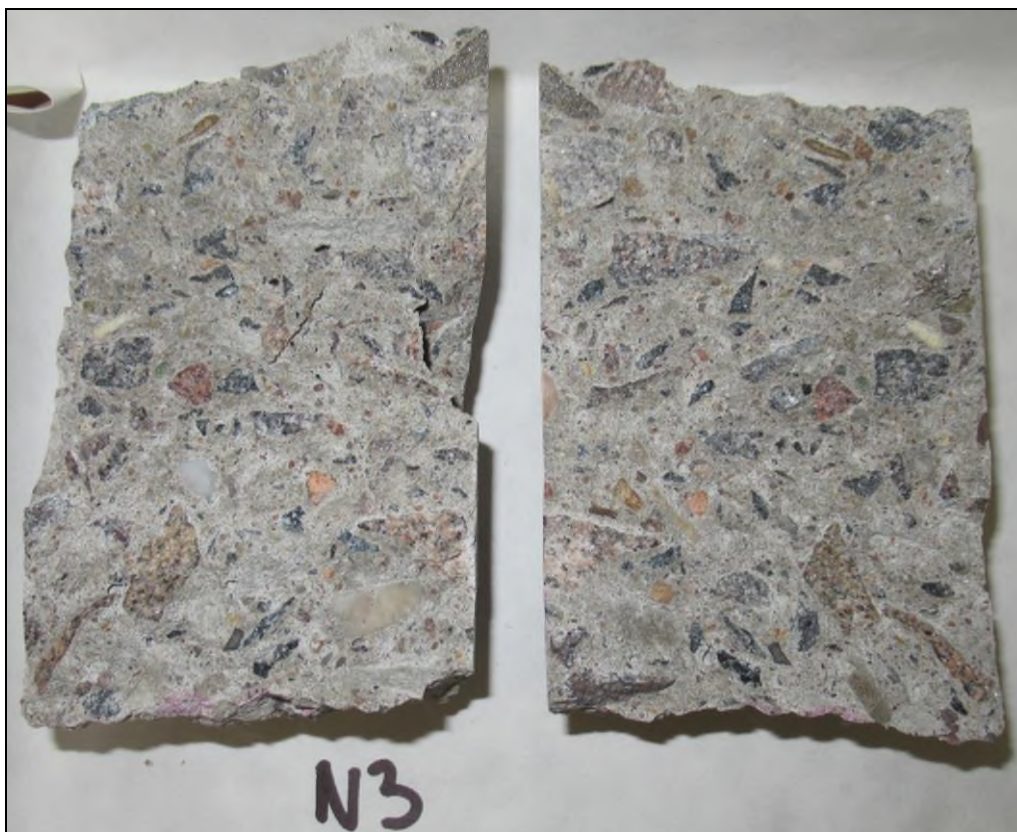
Foto 2: Části vzorku N3 před zkouškou na přítomnost ASR
