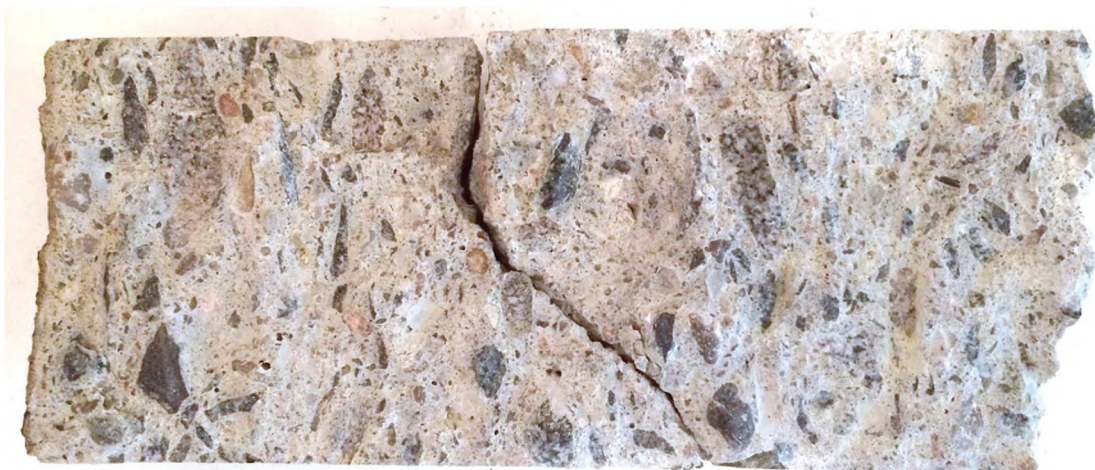
Obrázek č. 1: Fotodokumentace vývrtu 1/1-M1 – 1. polovina délky, pohled na zkoušenou lomovou plochu
