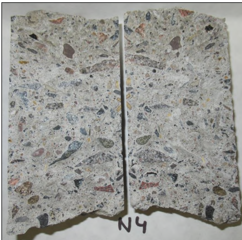
Foto 4: Části vzorku N4 před zkouškou na přítomnost ASR
