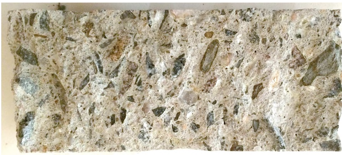
Obrázek č. 3: Fotodokumentace vývrtu 1/1-M1 – 2. polovina délky, pohled na zkoušenou lomovou plochu
